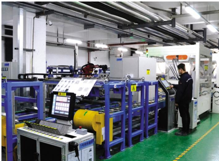
近年来,氨纶公司注重科技创新引领经济高质量发展,在八期自动包装车间大量采用机器人,极大的提高了生产智能化、自动化水平,大幅提升了生产效率,原来需要几十名员工进行包装工作,现在仅仅需要3-5名员工。图为员工在通过电脑控制自动包装机机器人对产品进行自动分拣包装。
